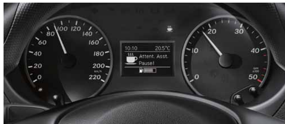
ATTENTION ASSIST (série) s'appuie sur de multiples paramètres pour détecter les signes de fatigue caractéristiques et alerter le conducteur.
