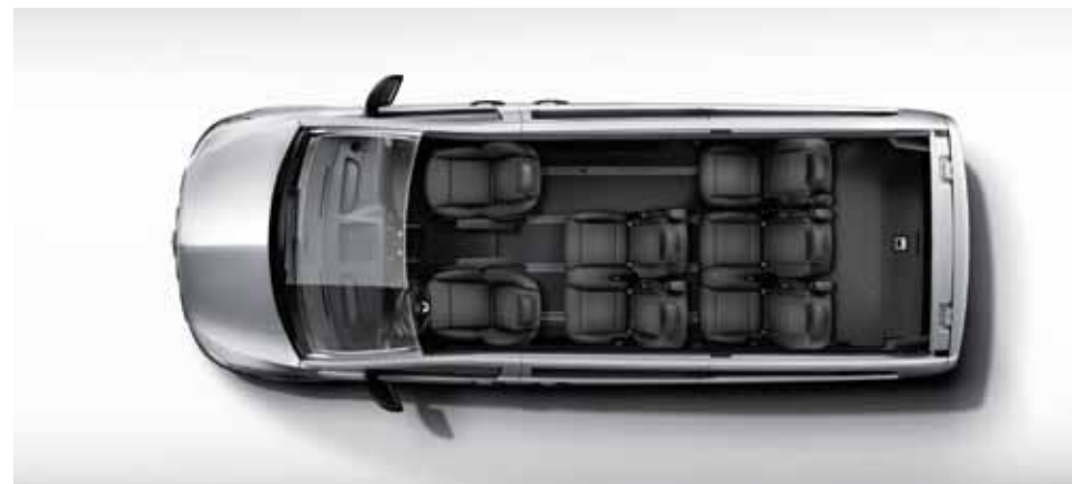
Vito Tourer extra long, banquette 2 places pour la première rangée de sièges et banquette 3 places pour la deuxième rangées de sièges et système de rails de guidage à verrouillage rapide dans l'espace passagers.
