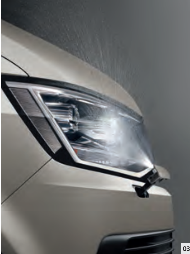
03 Lave-phares. Les gicleurs des lave-phares sont dissimulés dans le pare-chocs avant et se déploient en cas de besoin, puis redescendent. Couplé au système de lave-glace, le système de lave-phares est actif lorsque les feux de croisement ou les feux de route sont allumés. Les optiques des projecteurs sont nettoyés tous les cinq cycles de nettoyage du pare-brise. | CL | CA |
