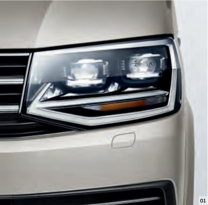
01 Projecteurs avant à LED. Les feux de route et les feux de croisement sont équipés de LED économes en énergie. La fiabilité et la longue durée de vie des LED améliorent la sécurité et leur luminosité, proche de la lumière du jour, augmente la visibilité. Pour les véhicules avec hayon, les projecteurs avant à LED ne sont disponibles qu'en association avec les feux arrière à LED. | CL | CA |
