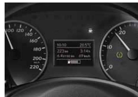
● Le **contrôle de la pression des pneus** surveille en permanence la pression de gonflage et alerte le conducteur lorsqu'elle diminue dangereusement.<sup>3</sup>
