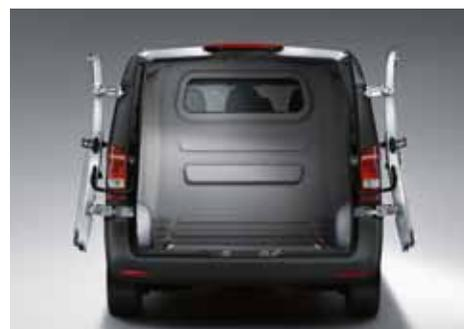
○ Les **portes arrière à double battant** peuvent être ouvertes jusqu'aux parois latérales et bloquées dans cette position afin de faciliter les opérations de chargement et de déchargement.<sup>2</sup>
