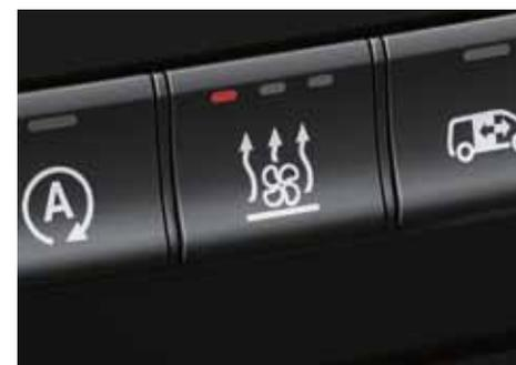
○ Grâce au **chauffage additionnel à eau chaude**, vous pouvez réchauffer ou aérer l'habitacle du Vito avant de démarrer.
