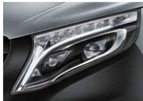
○ L'**Intelligent Light System à LED** adapte l'éclairage en fonction de la luminosité et des conditions routières et météorologiques.
