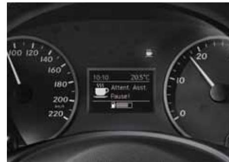
● **ATTENTION ASSIST** s'appuie sur de multiples paramètres pour détecter les signes de fatigue caractéristiques et alerter le conducteur.
