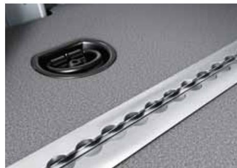
○ Le **système d'ancrage du chargement** à deux rails fixés au plancher arrière permet de sécuriser le chargement.
