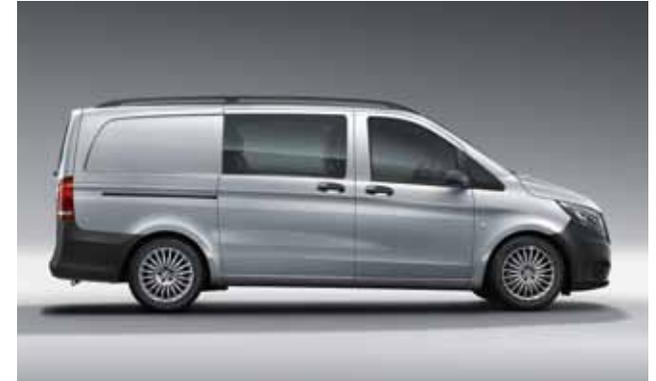
● Les **vitres entre les montants B et C** permettent à la lumière de pénétrer dans l'espace passagers et dégagent une bonne visibilité vers l'extérieur.
