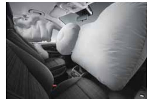
● L'**airbag passager avant à deux seuils de déclenchement** peut contribuer à diminuer le risque de blessures graves lors d'un accident.<sup>4</sup>
