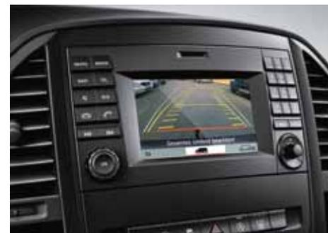
○ La **caméra de recul** permet de visualiser l'environnement et la trajectoire du véhicule en qualité photo à l'aide de lignes de guidage dynamiques.
