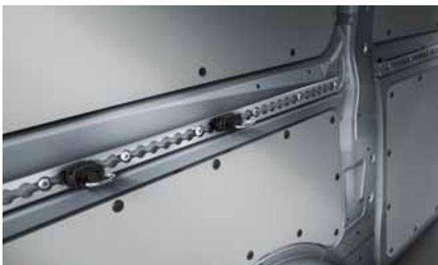
○ Les **rails d'arrimage sur les parois latérales du compartiment arrière** permettent d'éviter que le chargement ne glisse ou ne se renverse.
