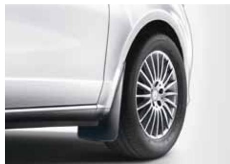
**Bavettes.** Elles protègent le soubassement et les flancs du véhicule contre les gravillons et les salissures. Disponibles par paires pour les essieux avant et arrière.
