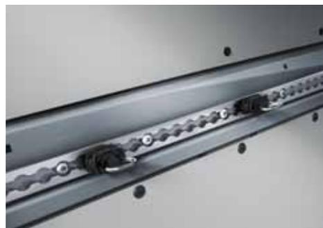
○ Les **rails d'arrimage sur les parois latérales du compartiment arrière** permettent d'éviter que le chargement ne glisse ou ne se renverse.
