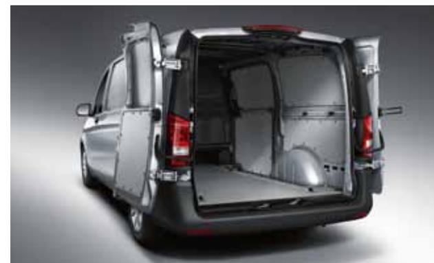
○ Les **portes arrière à deux battants** peuvent être ouvertes jusqu'à la paroi latérale (option) et bloquées dans cette position afin de faciliter le chargement/déchargement.
