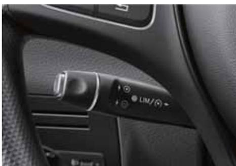
● Le **régulateur de vitesse TEMPOMAT** permet de maintenir une vitesse paramétrée et facilite ainsi la conduite.
