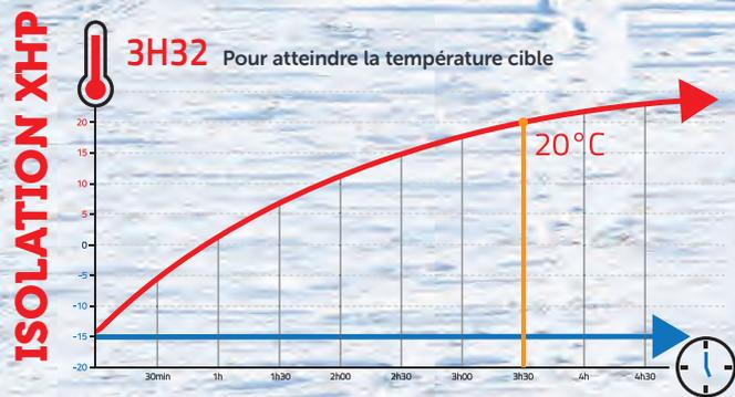
Test isolation et chauffage DREAMER / Norme EN 1646-1 / Truma Combi 4 par -15°C
